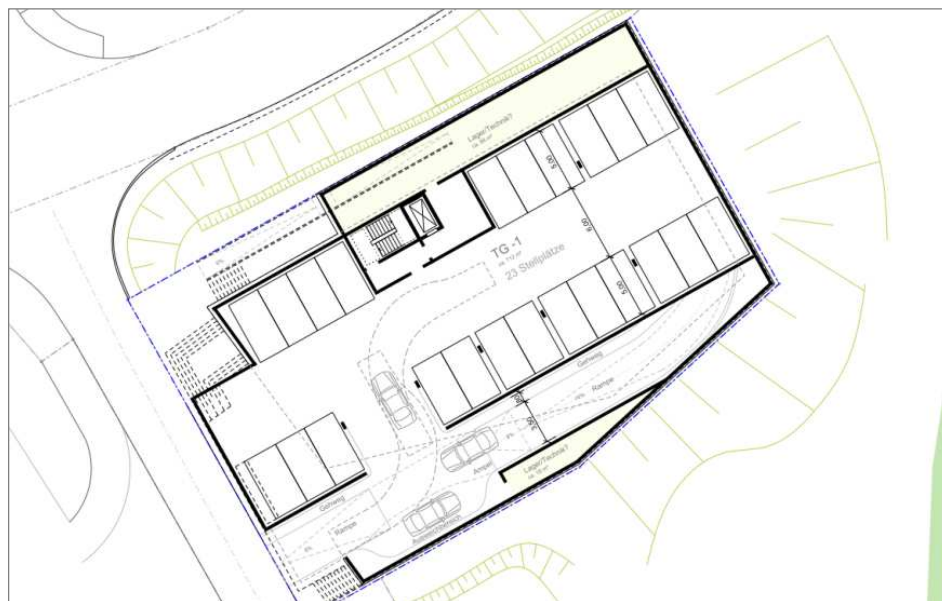
Abbildung 2: Konzeptplanung 1 UG mit 23 Stellplätzen und der TG-Zu-/Ausfahrt (Quelle: Steinhoff Hänel Architekten, Stuttgart, Stand 27.02.2019)
